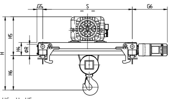
(\*) L'entraxe prévu de série est S=1000 mm, sur demande, il peut être fourni avec un écart S = 1200 mm
